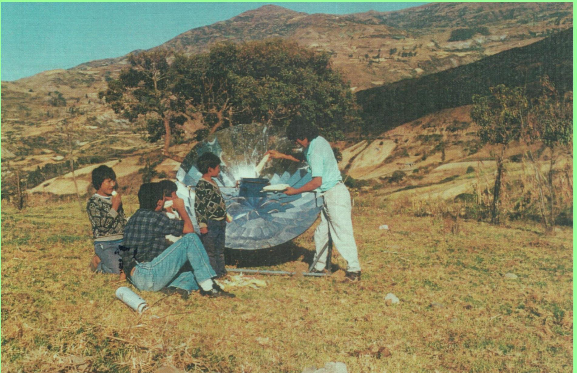
Der **Solarkocher** wird ohne Strom mit einfachen Werkzeugen hergestellt, die Reflexbleche sind fertig vorgestanz, die Fertigung schafft Arbeitsplätze vor Ort. In wenigen Monaten hat sich der Solarkocher über **eingesparte Brennstoffkosten** amortisiert.
