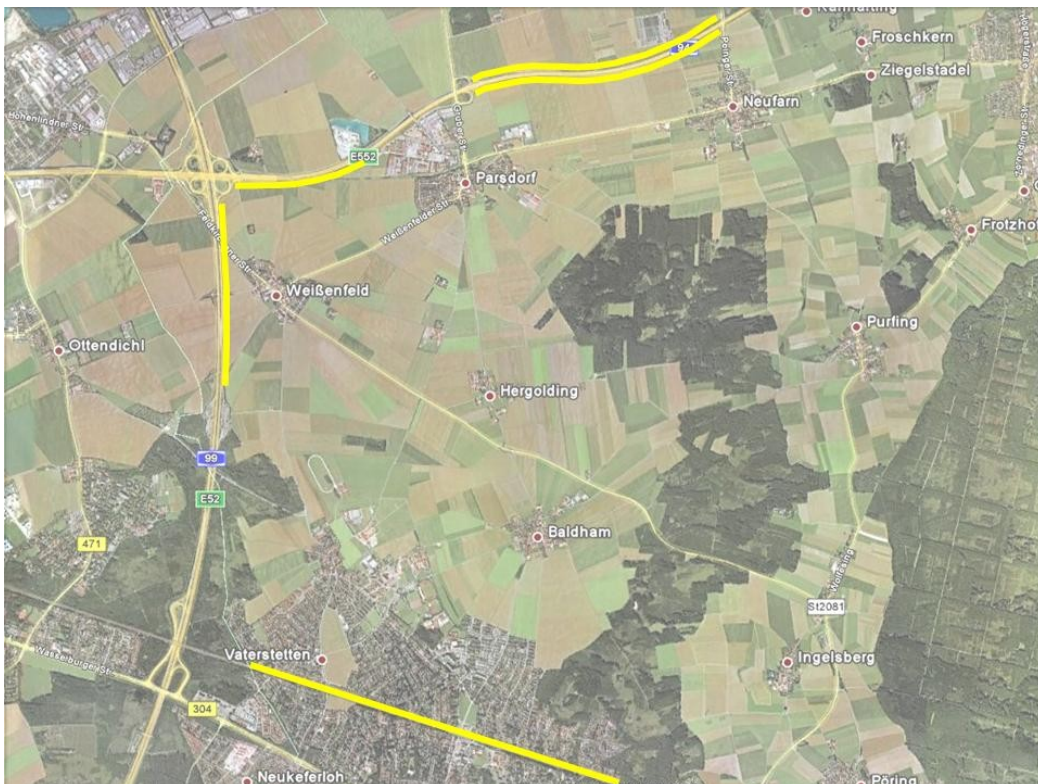
Bild 3: mögliche Standorte von Lärmschutz-PV-Anlagen
