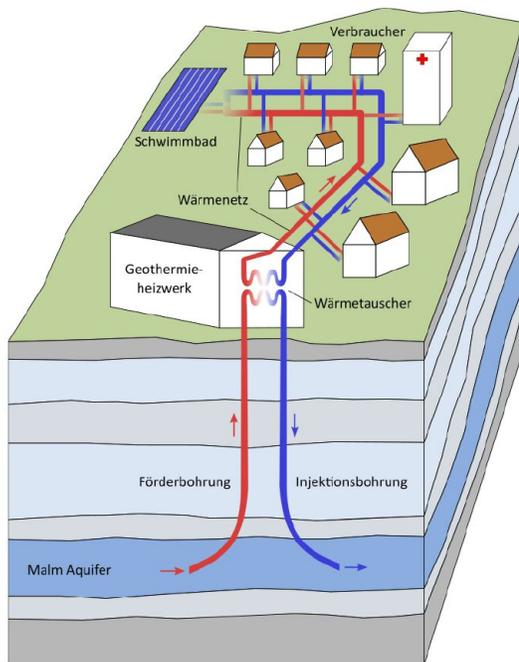
Schematische Skizze einer hydrothermalen Geothermieanlage mit Heizwerk und angeschlossenem Wärme-verteilnetz. Das heiße Wasser aus dem Reservoir (Malm Aquifer) wird über eine Förderbohrung zum Heizwerk geleitet und die Wärme an das Netz übergeben. Das abgekühlte Wasser wird über eine Injektionsbohrung in das Reservoir zu-rückgeleitet.
