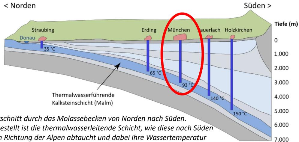
Querschnitt durch das Molassebecken von Norden nach Süden. Dargestellt ist die thermalwasserleitende Schicht, wie diese nach Süden hin in Richtung der Alpen abtaucht und dabei ihre Wassertemperatur zunimmt.
